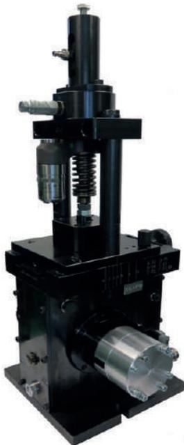
**CAM-BOX2 MECHANIC** устанавливается на стенде стандарта 125мм. Для стендов других стандартов применяется переходная плита не входящая в комплект поставки.
